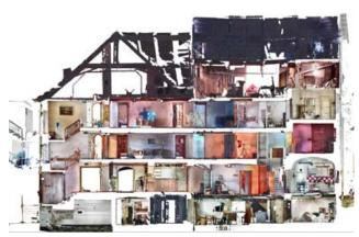
Eintauchen in den virtuellen Raum mittels einer Punktwolke. Querschnitt durch das bestehende 'Hotel Scaletta'
